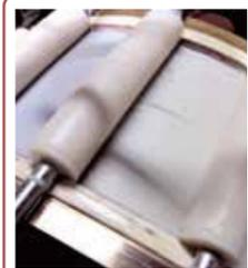
2 成型工程ではすり身の柔らかさの違いに応じて、ベルトの張りや水の量などを微妙に調整します。
