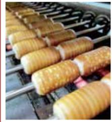
3 焼きは弾力をつくる最も重要な工程。ガス圧、バーナーの高さなどを調節し、黄金色に焼き上げます。
