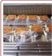
8 乾燥機で袋表面の水滴を飛ばします。この後、目視検査し、商品ラベルを貼って完成です。
