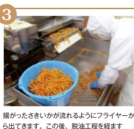
できあがったさきいか天を手作業で選別。かたまりやこげなどの不良品を取り除きます
