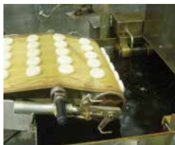
⑤ 160～170℃の油で揚げます。両面がムラなく揚がるように、途中、回転させながら揚げていきます。
