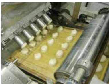
④ 練り上がったものを装置に入れて1枚分の量ずつ押し出し、ローラー（右側）をくぐらせて小判状にします。
